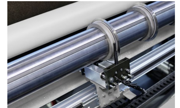
Automatische Messerpositionierung Für wiederkehrende genaue Schneidpositionen und Rüstzeitreduzierung bei Scherenschnitt.
