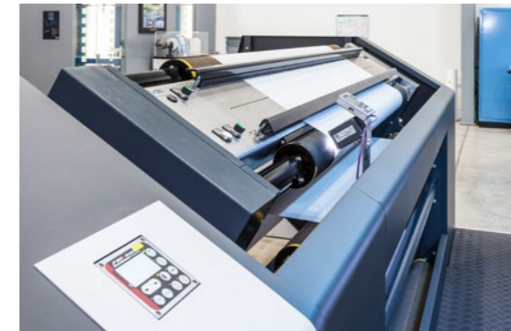
Klebetisch für Abwickler mit \varnothing 1.000 mm Hochwertige Klebestellen - leicht gemacht. Integrierter, fester Klebetisch.
