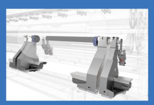
ATC防纵向皱纹系统 (专利申请中) 实现宽幅成品卷高速生产的智能组合系统, 可再提速高达30%。
